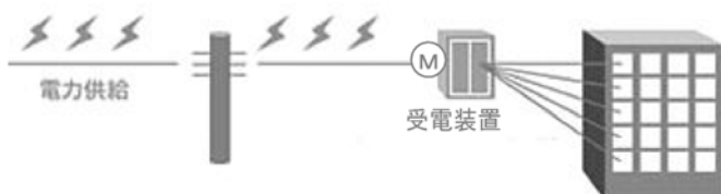
図2) 高圧電力一括受電による電力供給
