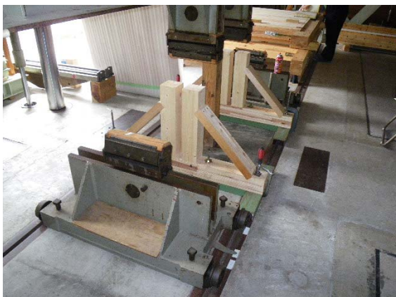
国産スギの導入に向けた強度試験の様子
