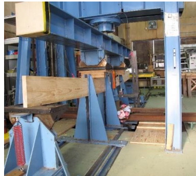
岩手県林業技術センターにて試験した アカマツ210の曲げ試験中の様子
